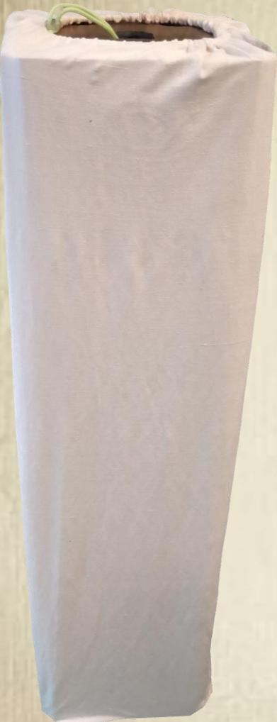
Pendant qu'une personne tient la colonne, une autre peut enfiler par le bas le sac blanc de protection de la colonne jusqu'en haut. Eviter de retourner la colonne.
