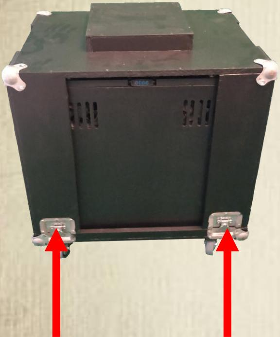
Serrer les 4 papillons du flightcase ( parfois il faut donner un peu de jeu aux montants du couvercle pour que les fermoirs soient bien alignés ).
