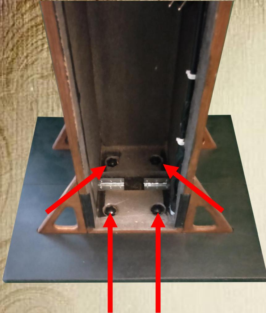
Dévisser les boulons dans la colonne ( entre la colonne et le plateau ), les ranger dans le sachet à l'intérieur de la colonne.
