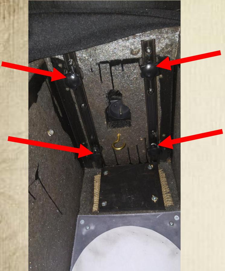
Dévisser les boulons dans la colonne ( entre la colonne et le photobooth ), les ranger dans le sachet à l'intérieur de la colonne.
